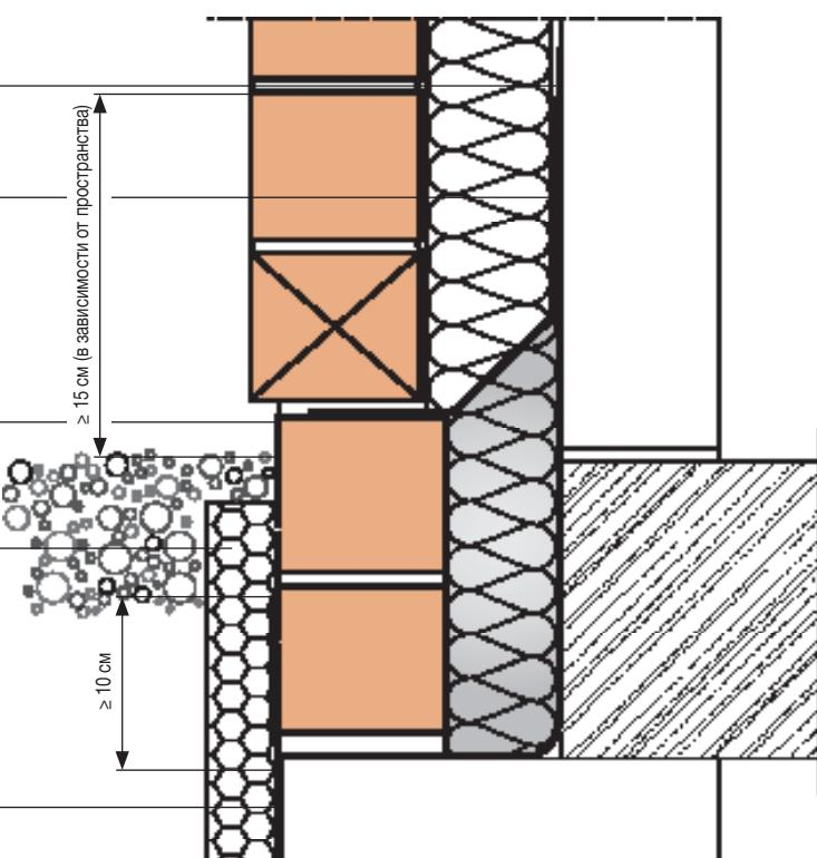
**Исполнение двухслойной наружной стены, примыкание цоколя**
