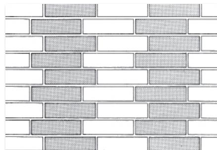
Ложковая перевязка со сдвигом
