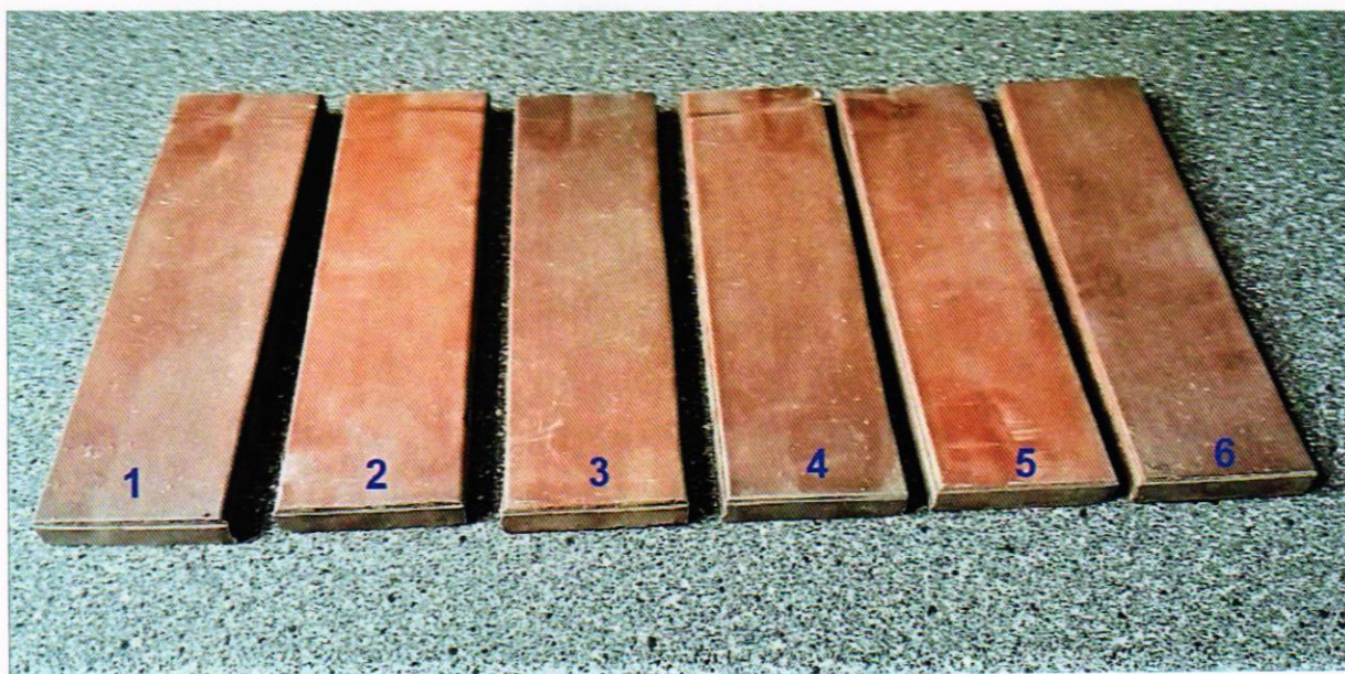
Фото 3. Испытанные ( №1, №2,№3,№4,№5) и контрольный (№6) образцы плитки.
